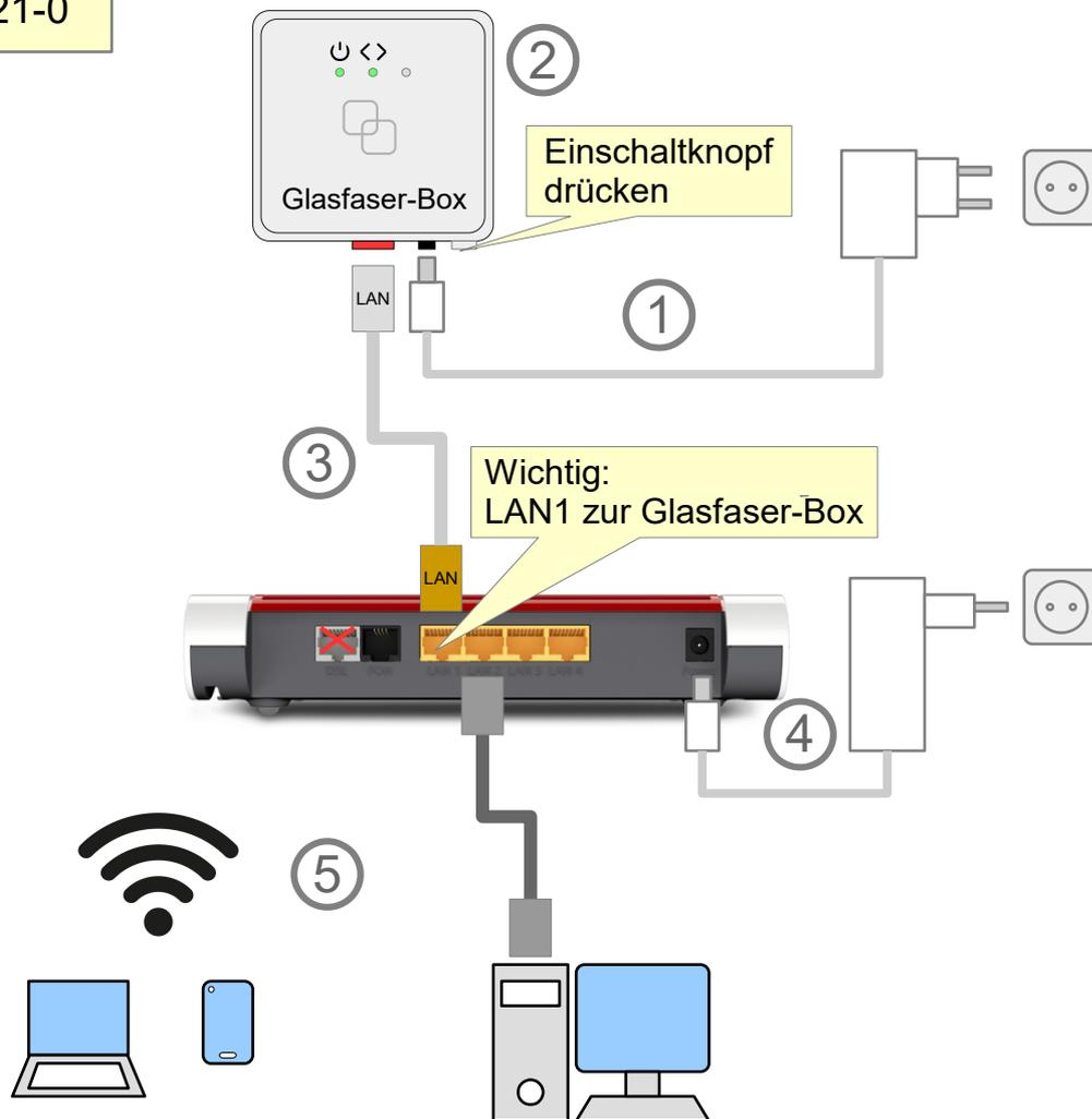
1) Glasfaser-Box am Strom anschließen und einschalten. (Knopf drücken)
